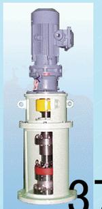
②攪拌軸の固有振動数(一般には危険回転数と呼ばれる)を把握し、これを避けるような対処が必要である。全ての物体にはそれ固有の振動数を持っており、この振動数と攪拌機の運転回転数が合致するといわゆる共振現象が発生し、軸が激しく振れ、運転が出来なくなったり、軸の損傷という事故を引き起こしかねない。変速範囲の中にこの固有振動数が存在しなければ問題ないが、どうしても避けられない場合も多い。特にインバータのように変速範囲が広いとなおさらである。この回転数区域は速やかに通過するようになる必要があるが、インバータの周波数をダイヤル(周波数変更ボリューム)で手動変更させると、時として時間がかかり、その間に軸を曲げてしまったという事故も実際にはある。このような場合は、インバータの機能のひとつである周波数のジャンピングを利用し、危険回転数域の回転数に相当する周波数は出力せず、一瞬で次の周波数に移行させるような設定が必要である。
