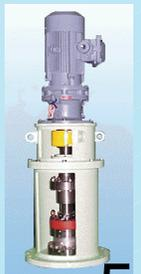
実際に種々の翼形状、翼枚数、邪魔板の有無、偏心取付け、液面の変動など様々の条件を変化させてアンバランス水力を測定した結果、アンバランス水力を小さくするためには翼の枚数を多くするほうが良く、また攪拌槽の中心に取り付け、邪魔板の枚数も多く、しかも対称に設置することがよかった。特にアンバランス水力を増加させる条件は偏心取付の場合であり、偏心量によりその値は変化するが、最大では中心取付の場合の3～4倍の力が働くことが測定されている。したがって偏心取付は攪拌軸には非常に苛酷な条件となり、攪拌軸に係わる不具合の原因のひとつに挙げられている。一般に邪魔板を設置しない代わりに偏心取付をするとよいとされているが、以上のような理由と攪拌効果についても邪魔板付きの場合と同等というわけでもないのだから、邪魔板付きで中心取付にするようにすべきである。
